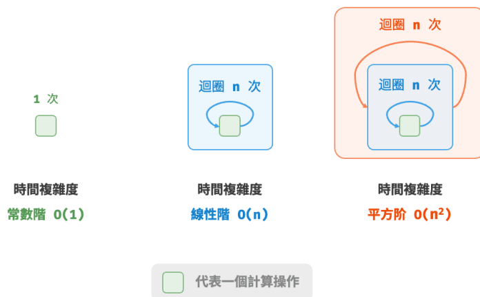
圖 2-10 常數階、線性階和平方階的時間複雜度
