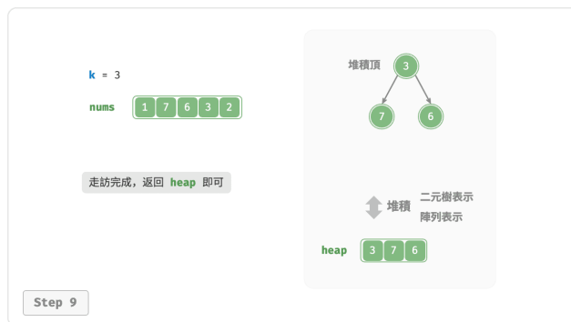
圖 8-8 基於堆積尋找最大的 k 個元素
