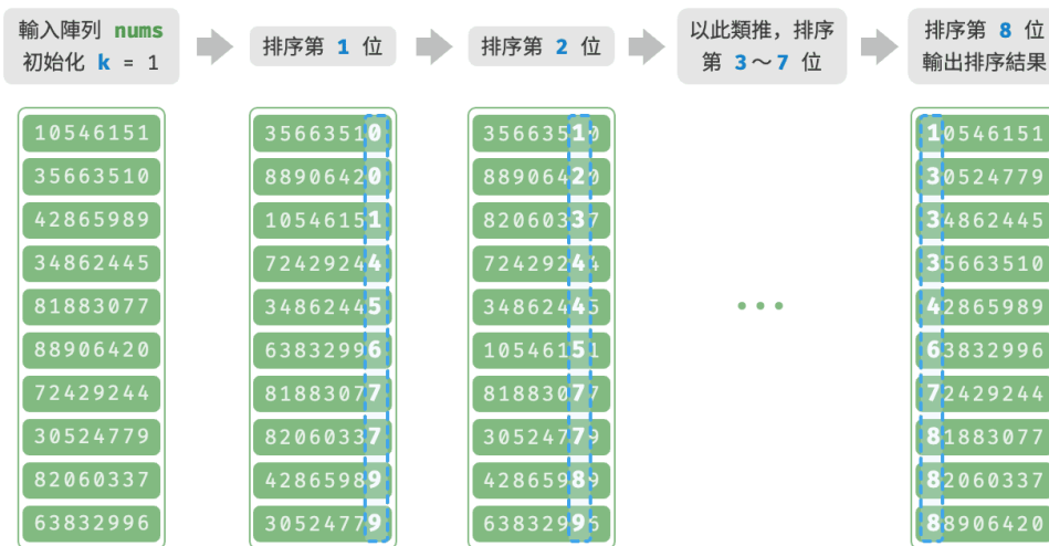
圖 11-18 基數排序演算法流程
