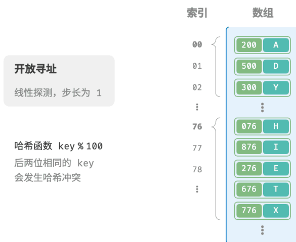
图 6-6 开放寻址（线性探测）哈希表的键值对分布
