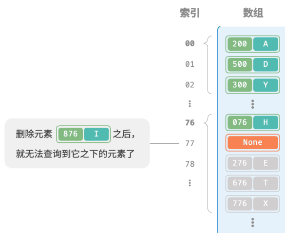
图 6-7 在开放寻址中删除元素导致的查询问题
