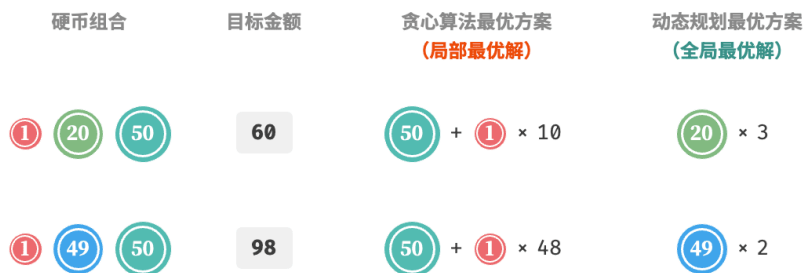
图 15-2 贪心算法无法找出最优解的示例
