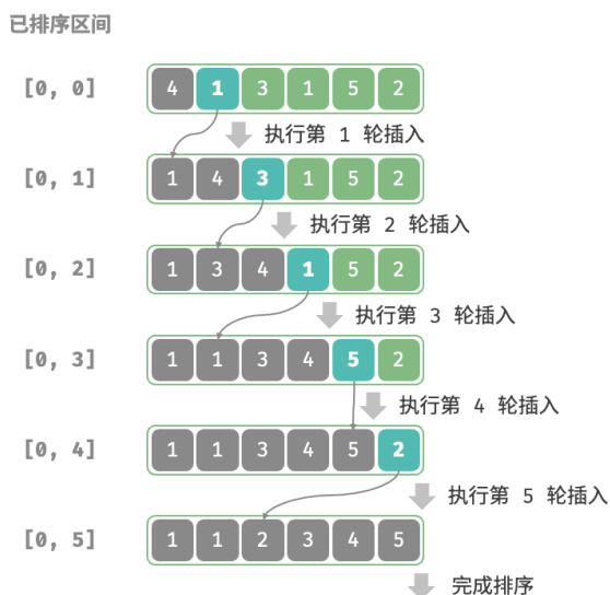
图 11-7 插入排序流程
