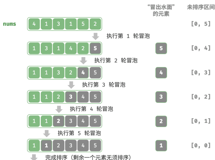
图 11-5 冒泡排序流程
