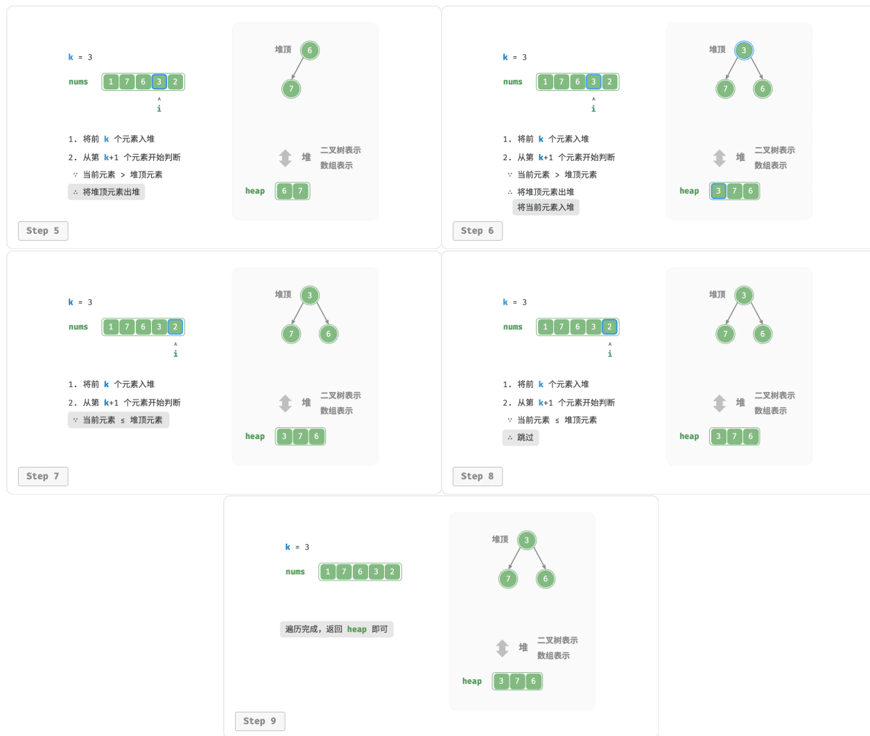
图 8-8 基于堆寻找最大的 k 个元素
