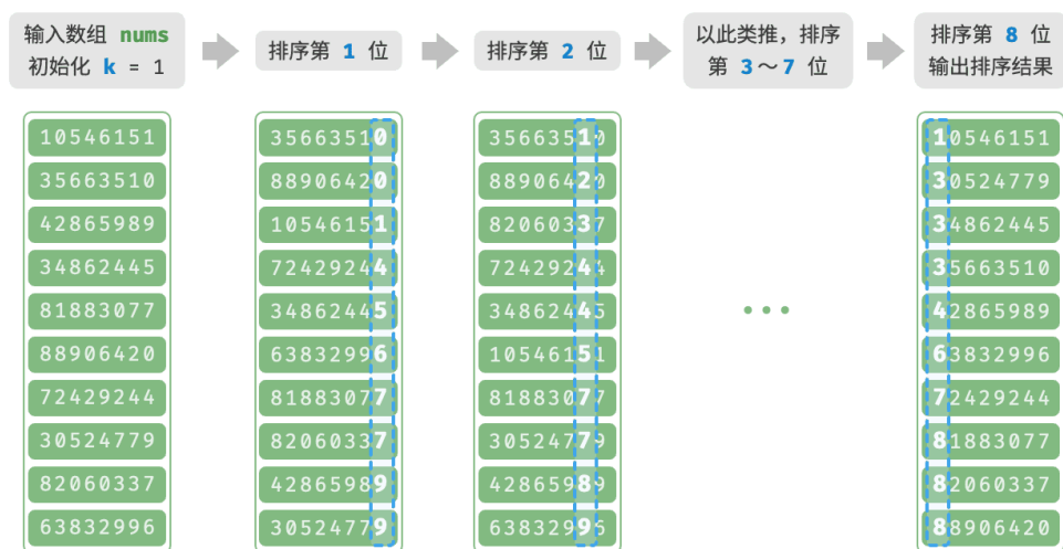
图 11-18 基数排序算法流程
